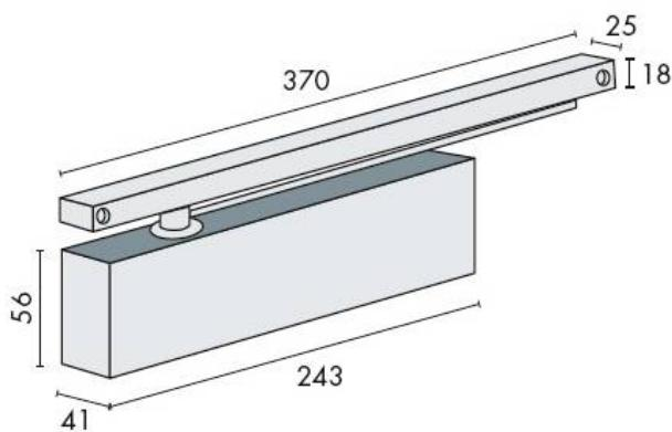
Ferme-porte à bras à glissière à crémaillère elliptique, force 1-4 suivant norme EN 1154 A. Réglage de la vitesse de fermeture et de l'à-coup final par vis, freinage à l'ouverture non réglable, capot anti-vandalisme. Pour portes de largeur maximum : 1100 mm
