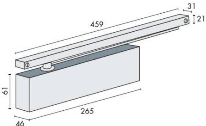
Ferme-porte à bras à glissière à crémaillère elliptique, force 1-4 suivant norme EN 1154 A. Réglage de la vitesse de fermeture et de l'à-coup final par vis, freinage à l'ouverture réglable, capot anti-vandalisme. Pour portes de largeur maximum : 1100 mm
