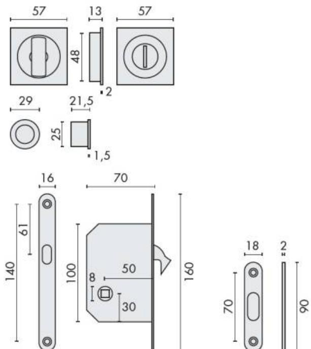
Kit pour portes coulissantes composé d'une cuvette condamnation et d'une cuvette à décondamnation actionnant une serrure à mantoné et une prise de doigt sur le champ de la porte
