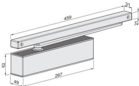
Ferme-porte à bras à glissière à came, force 2-5 suivant norme EN 1154 A. Force de fermeture réglable par vis.Réglage de la vitesse de fermeture et de l'à-coup final par vis, freinage à l'ouverture réglable capot anti-vandalisme Inox. Pour portes de largeur maximum :1250 mm
