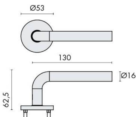
Paire de béquilles sur rosaces rondes à visser, L16 mm modèle "Project 01", conforme à la norme EN1906 grade 4. Rosaces intégrant un ressort de rappel + douilles pour vis traversantes pré-montées et sous construction acier inoxydable. Finition inox brossé AISI 304.
