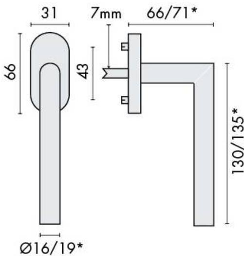
Béquille de fenêtre L90° D=19 mm modèle "Project 06", sur rosace d'épaisseur 11 mm à sous construction métallique, mécanisme click-stop pour système oscillo-battant, tube creux, fixations invisibles par vis M5 entraxe 43 mm.
