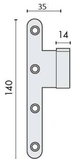
1/2 Paumelle EXS 1.61-F, 140\*70 bouts ronds. Femelle droite inox brossé, nœud diamètre 14 mm, coins arrondis sans bague d'usure de 3 mm
