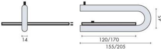
Supports Ø 14 mm pour tablette en verre d'une profondeur de 120 mm
