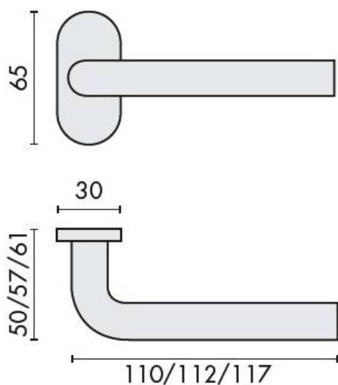
Paire de bâquilles L 19 mm, montée sur rosace fine de 4 mm à sous construction aluminium, avec roulement à billes, offrant 2 points de fixations permettant la pose de vis traversantes
