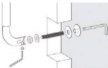
Fixation PS pour poignée de tirage, montage simple traversant pour porte bois ou vitrée
